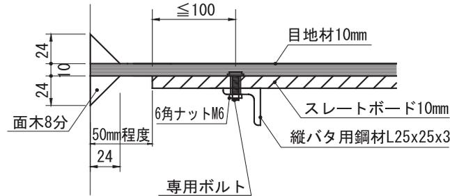
スレートボードの端部組立詳細平面図(片側のみからの打設の場合)
