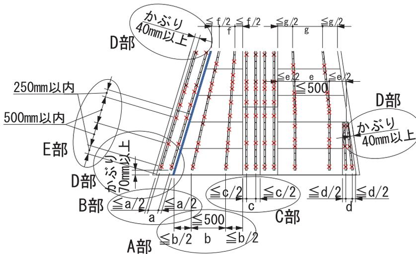
設置基準図(挟み打ち施工の場合)
