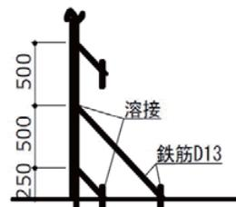
※下端から250mmと750mmの位置から打ち込んだアンカー筋へ、斜め下方45度でD13の引張り筋をあて、両端を溶接固定します。それ以降は500mm間隔で固定していきます。
