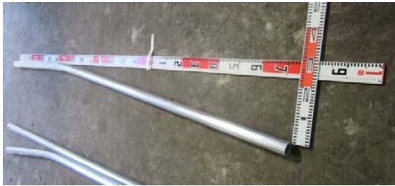
(a) 左側支柱 水平変位量225mm
