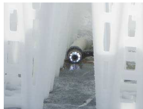
槽内点検カメラ & クリーンロボ
