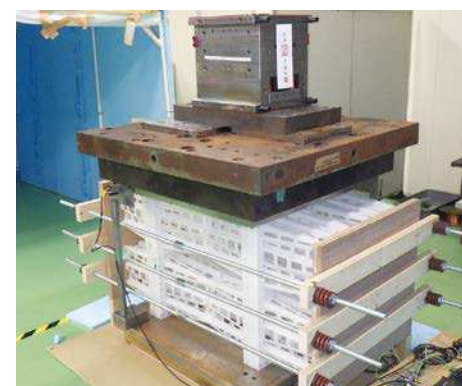
水平方向長期クリープ試験
