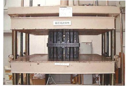
耐圧強度試験
